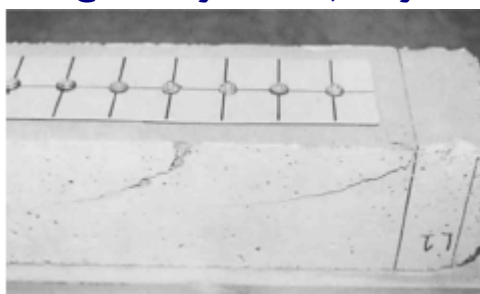
شکل ۸- کاربرد بست مکانیکی برای اتصال ورقه FRP در تقویت خمشی به تیر بتن آرمه [۵]
